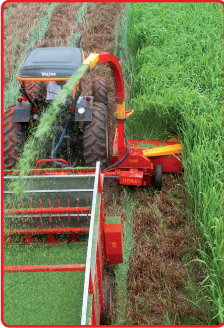
PMCD 1.3 - Plataforma recolhadora de capim e gramíneas plantados em área total, com 3 discos de corte. Plataforma cosechadora de pasto y gramíneas en área total, con 3 (tres) discos de corte.
