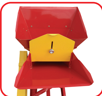
Entrada para espiga de milho com maior abertura e reservatório para grãos de 80 kg, no Triturador 303
