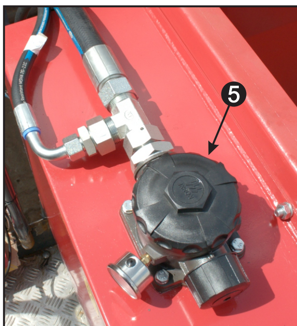
Foto. 24 - Filtro de Retorno Tanque Hidráulico
