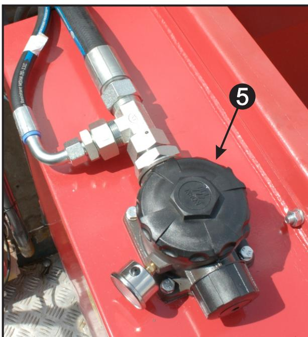
Foto. 24 - Filtro de Retorno Tanque Hidráulico
