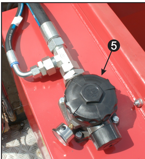
Foto. 25 - Filtro de Retorno Tanque Hidráulico
