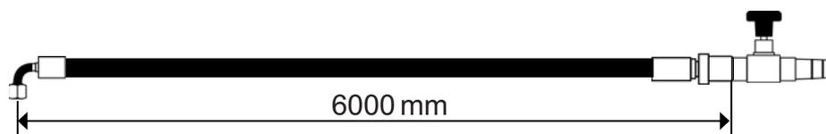
1. Conectar as duas mangueiras ao cilindro hidráulico (S) do quebra-jato.
