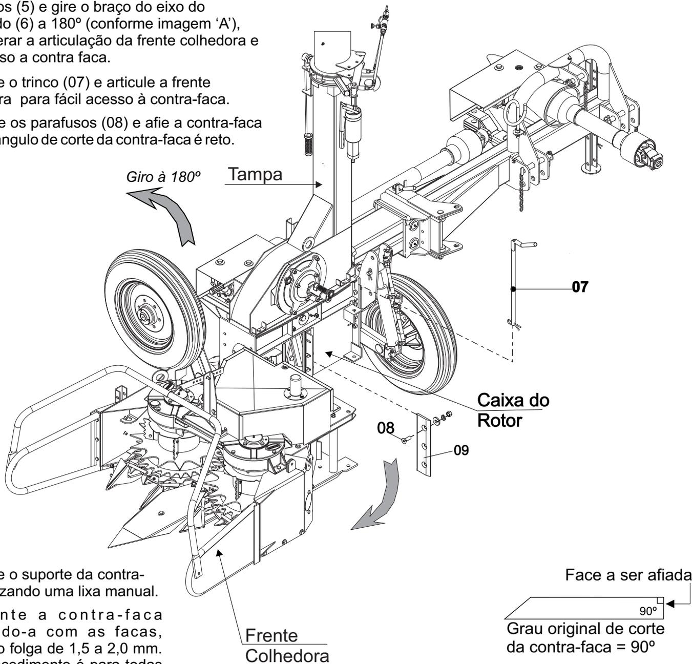
D) Limpe o suporte da contra-faca utilizando uma lixa manual.
