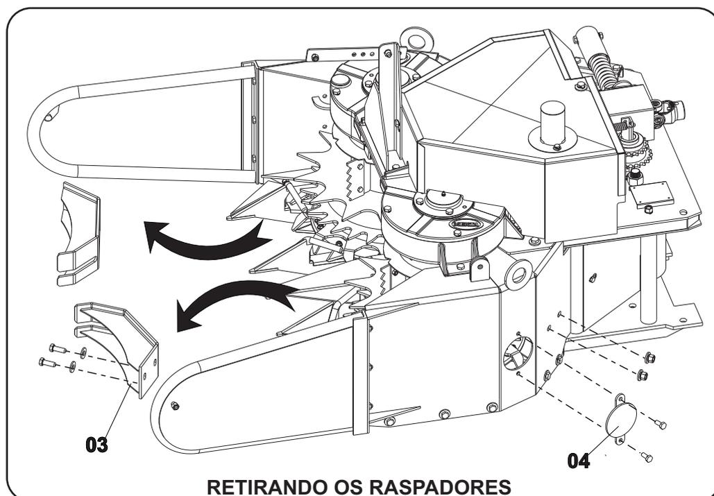
c) Para colheita de capins e necessário retirar os raspadores (3) faça isso primeiramente retirando a tampa de acesso na lateral da plataforma (4) de ambos os lados e posteriormente girando as carambolas para os raspadores saírem pela frente da plataforma.
