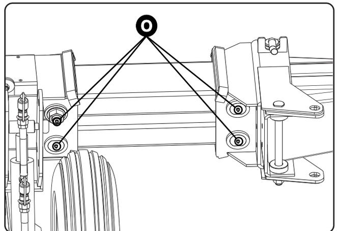
**NOTA:** Para lubrificação da junta agrícola é necessário a abertura da abertura da plataforma para ter acesso ao bico graxeiro, aproveitando a ocasião fazer uma limpeza no rolete e verificar a contra face se a necessidade de ajuste.
