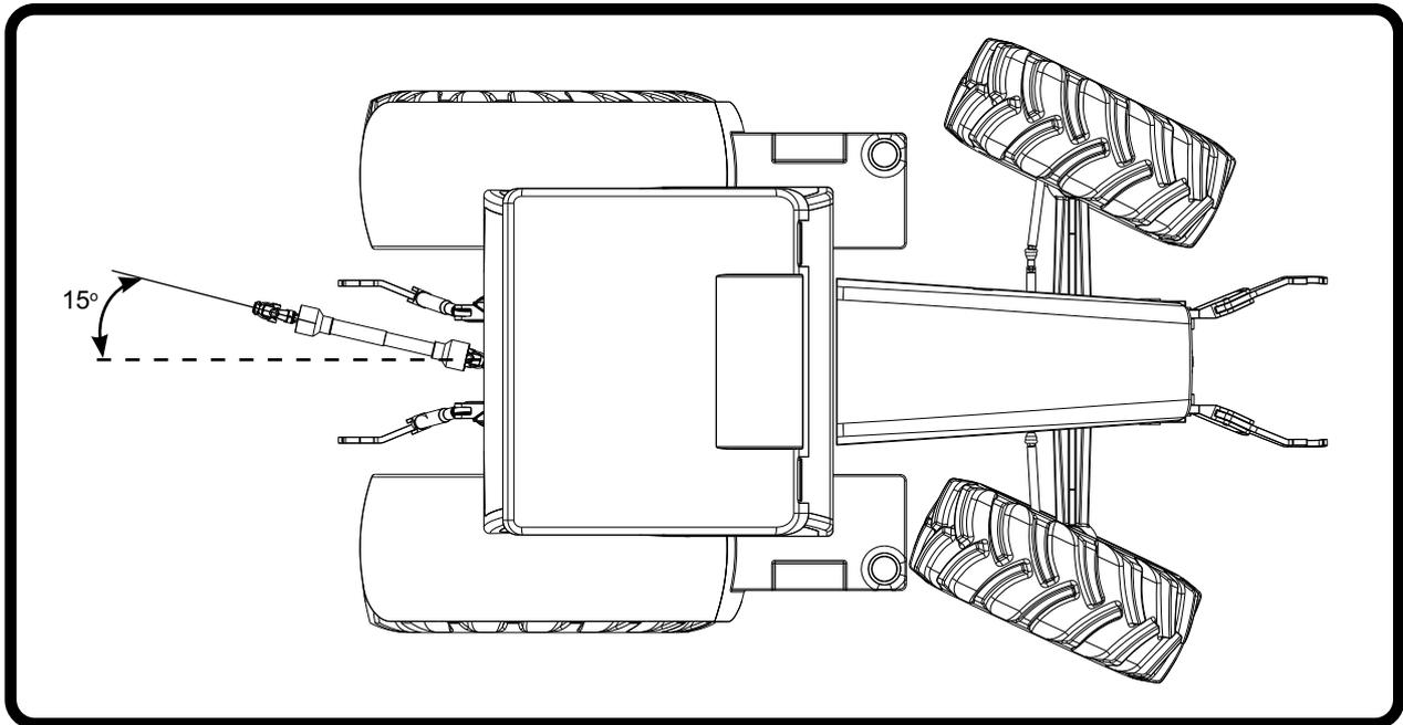
Na condição normal de trabalho, com o implemento na horizontal e deslocando em linha reta, a superfície de contato entre o tubo e a barra deve ser de 2/3 do comprimento total do cardan.
