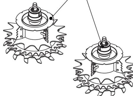
d) Retire os roletes (06) e os anéis elásticos (09) e com o auxílio de um tarugo de nylon ou madeira bata em uma das pontas do eixo (07), em seguida retire os rolamentos (08), avalie as condições, caso necessário troque-os.
