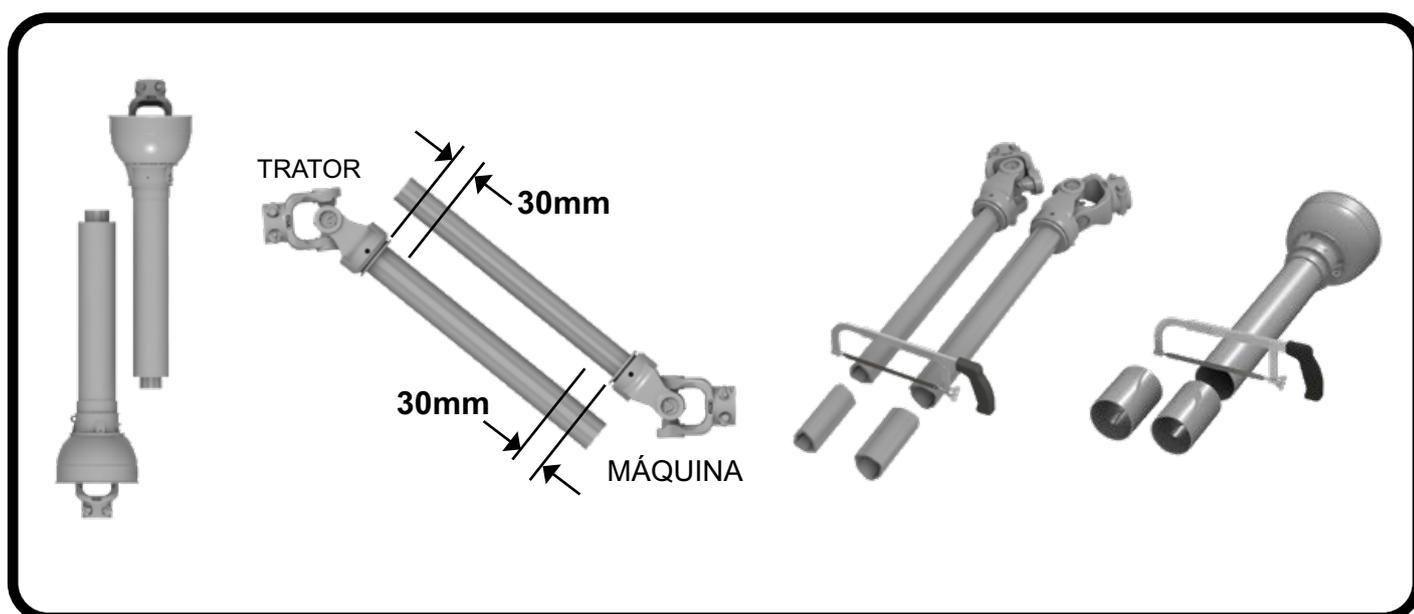
4. Desacople o cardan da máquina e do trator e proceda os cortes.
